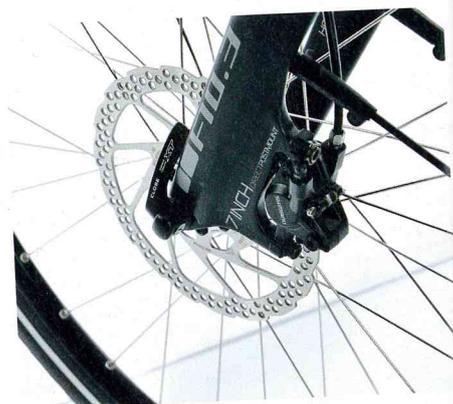
Steif: die Carbonsattelstütze. Sattelverzögerung: hydraulische Shimano Scheibenbremsen.
