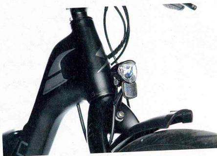
Stabiler Steuerkopf, steife Carbonsattelstütze und eine helle B&M Frontlampe.
