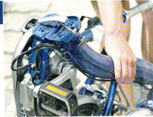
Einfacher Klappmechanismus, dank Magneten hält das Paket ohne Gurte zusammen
